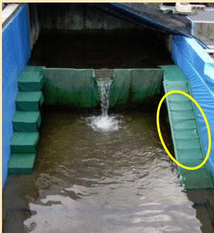
<斜路による遡上確認試験>
